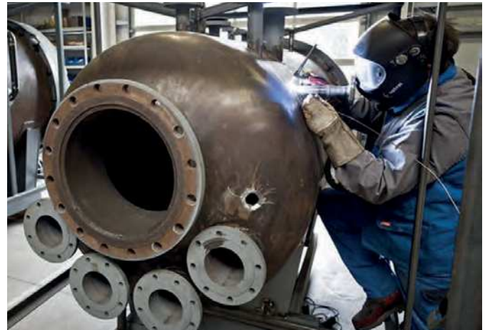
Dampfautoklaven von MK Technology: Sie sind für den Einsatz von Hochdruck- und Hochtemperaturdampf zur Abtötung von Mikroorganismen ausgelegt.
